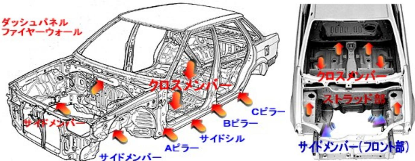
剛性感向上等の効果が得られる**基本的な貼り付け箇所**としては、写真の様にAピラー下部、サイドシル前部です。装着面を脱脂後、綺麗にしてから貼り付けて下さい。(密着性が重要なので面に合わせた貼付をして下さい。) 水平位置、垂直位置によって効果が違ってきますので、色々お試し下さい。(車の下回りに貼る場合は脱落防止の為にアルミ粘着テープ等で覆って下さい。)
